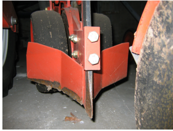
Billede 3. Anvend sporryddere foran såhusene, hvor der ligger jordknolde, sten, majsstubbe eller græstørv på jordoverfladen
